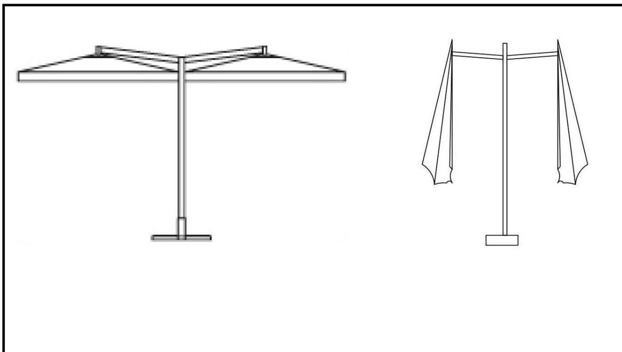
In generale la proiezione al suolo degli ombrelloni e tende non deve superare i limiti dell'area in concessione. Le estremità delle tende e le punte delle stecche degli ombrelloni devono avere un'altezza dal suolo min. mt. 2,20 e max. mt. 2,50.
