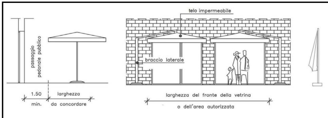
4-ombrellone multiplo, con struttura di supporto in legno e/o metallo con base zavorrata in appoggio o fissata alla pedana se prevista, con ombrello a pianta quadrata, rettangolare, poligonale o circolare, e mantovana terminale (vedi figura con funzione esemplificativa);
