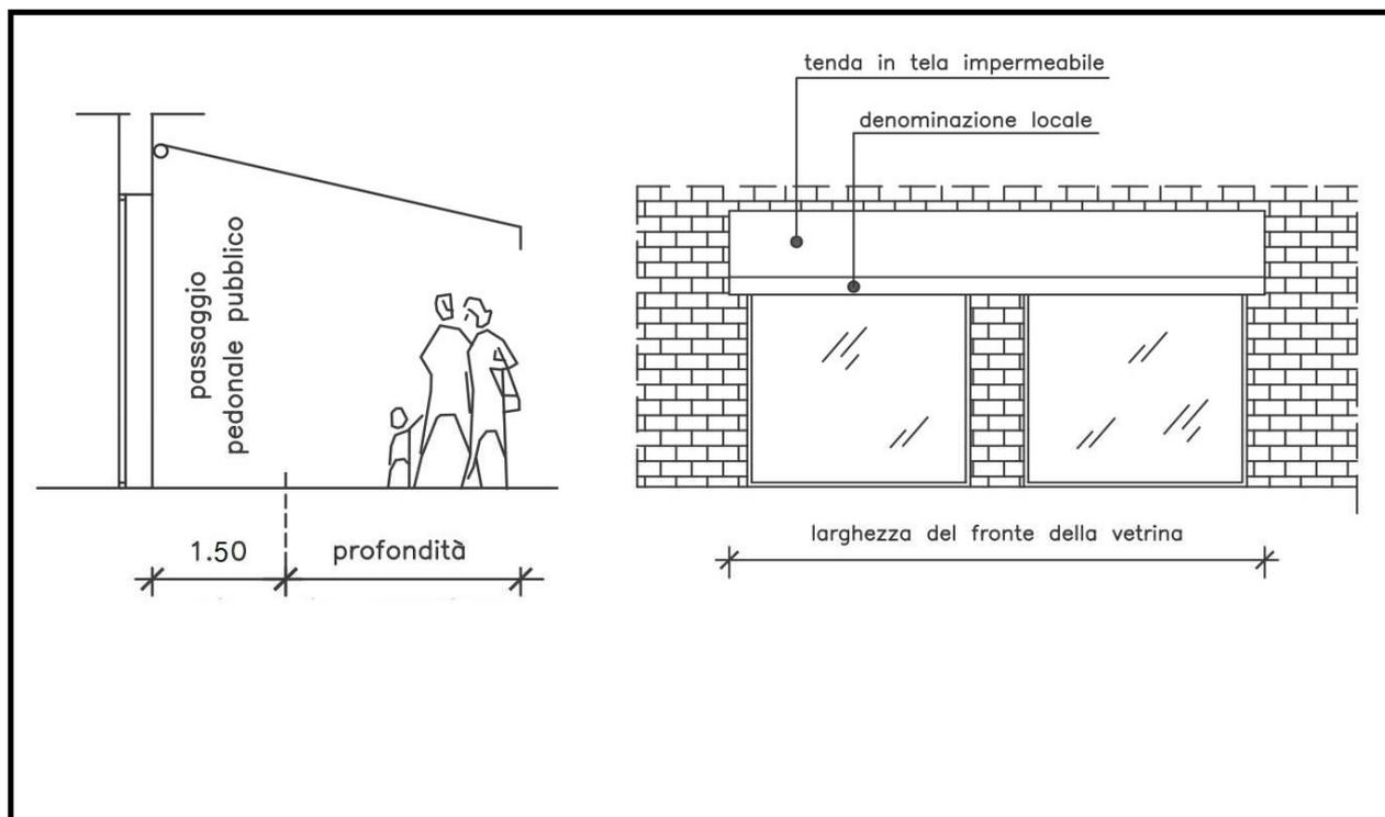
2- tenda piana avvolgibile a falda unica o doppia, con telaio di supporto metallico a bracci autoportante e mantovana terminale con eventuale inserimento di testo/logo attività in conformità a norme comunali di riferimento; altezza max mt. 3,5 (vedi figura con funzione esemplificativa);
