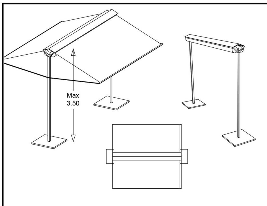
3-ombrellone a palo centrale o laterale, con struttura di supporto in legno e/o metallo con base zavorrata in appoggio o fissata alla pedana se prevista, con ombrello a pianta quadrata, rettangolare, poligonale o circolare, e mantovana terminale (vedi figura con funzione esemplificativa);
