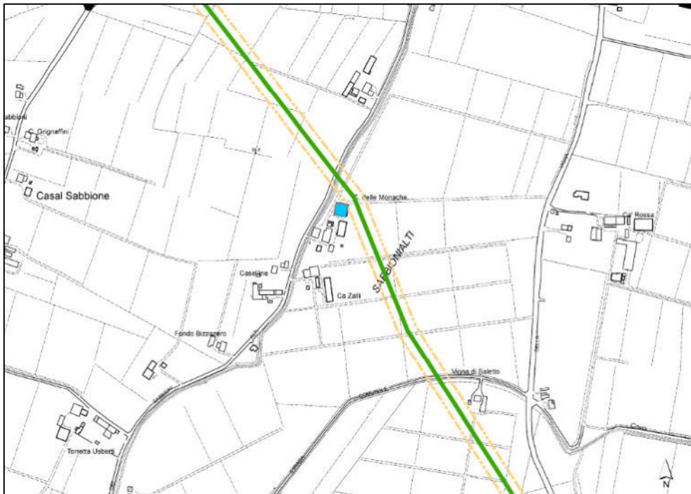
Figura 1.1.2 - Inquadramento su CTR delle porzioni di edifici interessati dalle distanze di prima approssimazione della linea AT 138 kV Soragna – Fontevivo (fuori scala).
