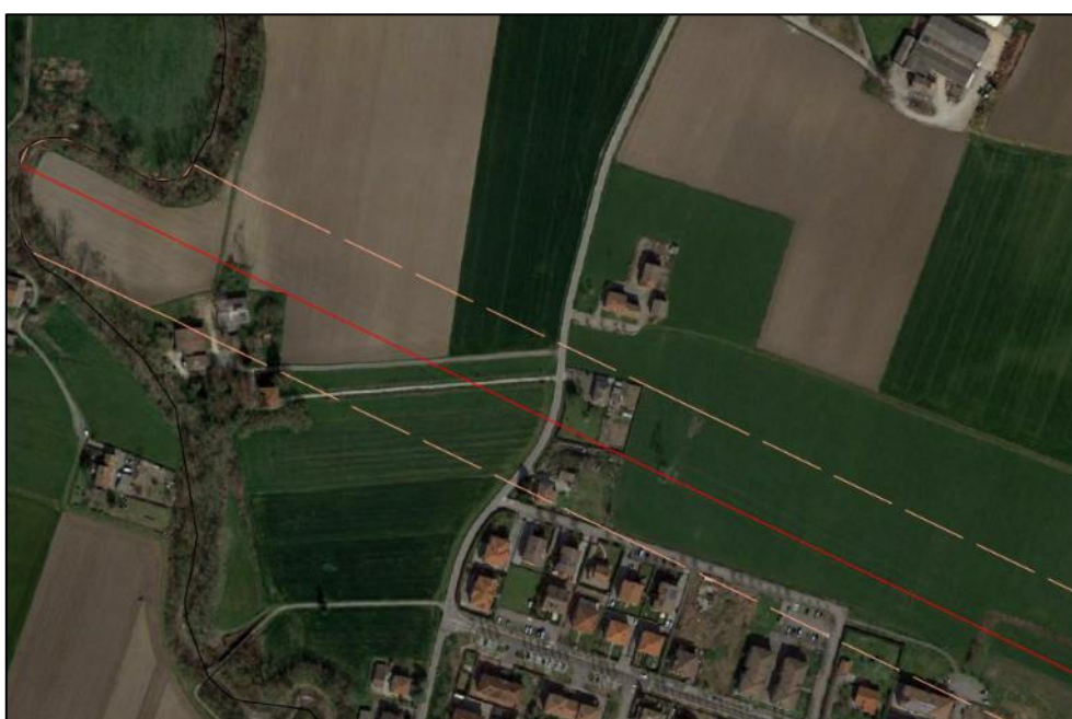
Figura 1.1.7 - Inquadramento su foto aerea (Google Earth – acquisizione immagine 18-03-2020) delle porzioni di edifici residenziali interessati dalle distanze di prima approssimazione della linea AAT 380 kV (fuori scala).
