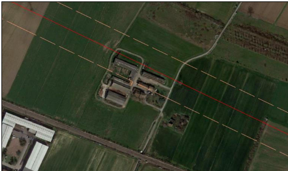
Figura 1.1.10 - Inquadramento su foto aerea (Google Earth – acquisizione immagine 18-03-2020) delle porzioni di edifici ad uso agricolo interessati dalle distanze di prima approssimazione della linea AAT 380 kV (fuori scala).
