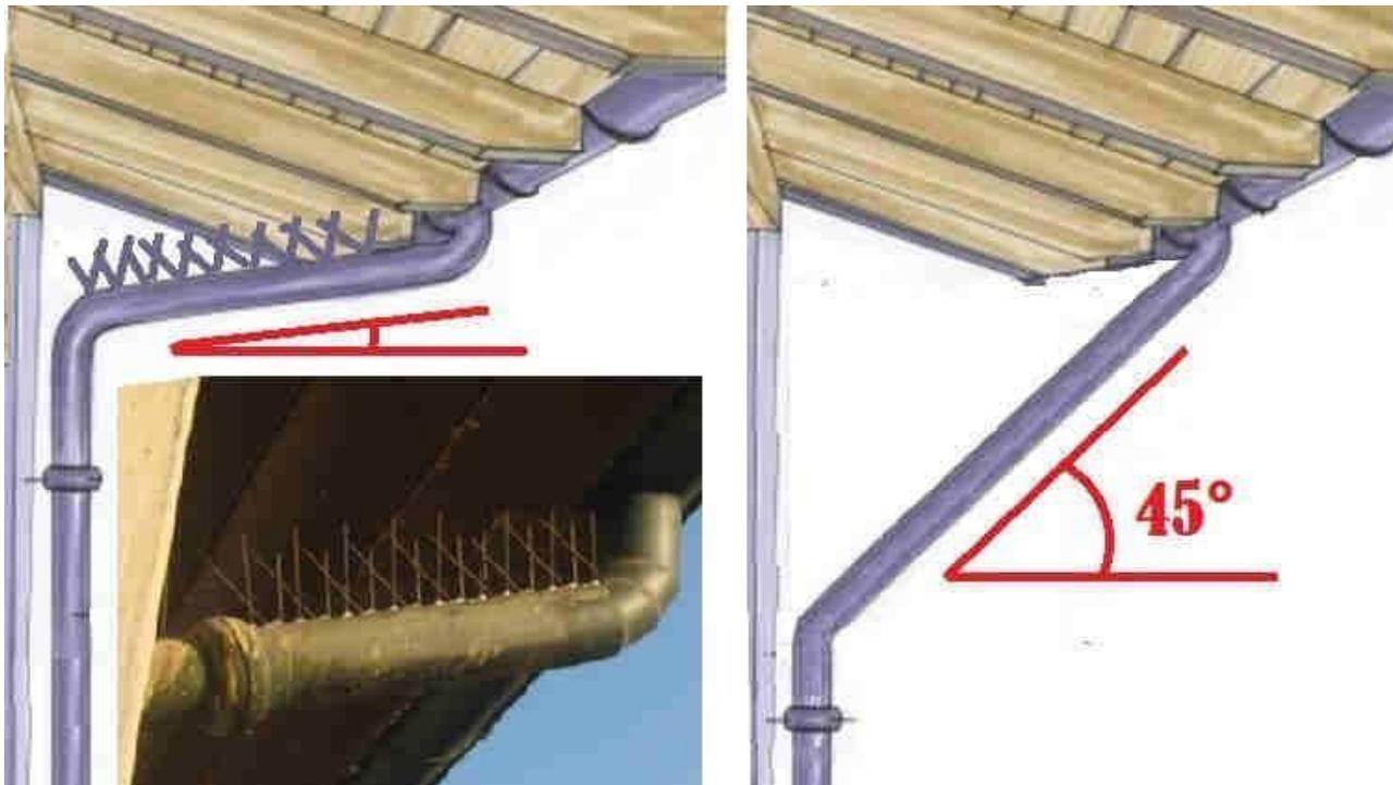
Nell'immagine di sinistra si vede come si può rimediare con le punte ad una situazione di presa di possesso da parte dei colombi del tubo montato in posizione quasi orizzontale, nell'immagine di destra si vede un pluviale montato in modo da evitare l'appoggio del Colombo.
