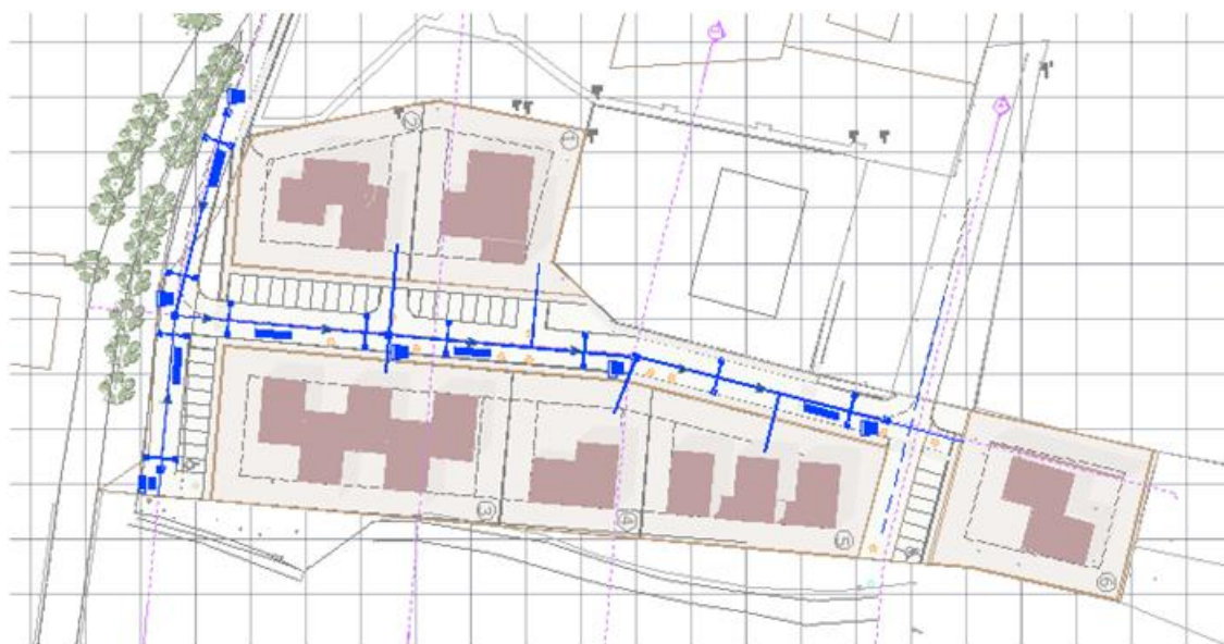
Figura 3: Individuazione planimetrica della dorsale per la raccolta delle acque meteoriche.
