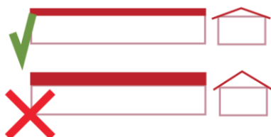
Fig. 3.3.2 Falde larghe a bassa inclinazione in quanto meno visibili dalle grandi distanze, negli edifici non abitativi di grandi dimensioni
