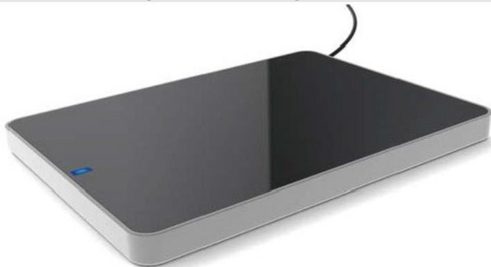
Le postazioni staff permettono ai bibliotecari di leggere le etichette RFID applicate alle risorse, essendo dotate di antenne schermate non subiscono interferenze dovute ad arredi o apparati elettronici nelle vicinanze. L'apparecchio di misure contenute ottimizza l'utilizzo dello spazio della scrivania.
