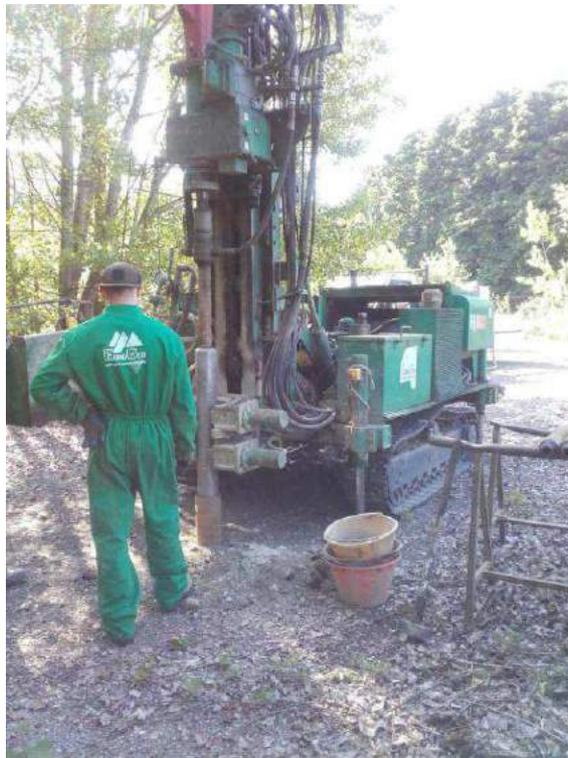
Sulla base del materiale campionato sono state ricostruite le litologie attraversate dal sondaggio, del tutto coerenti con quanto già rilevato nelle precedenti indagini.
