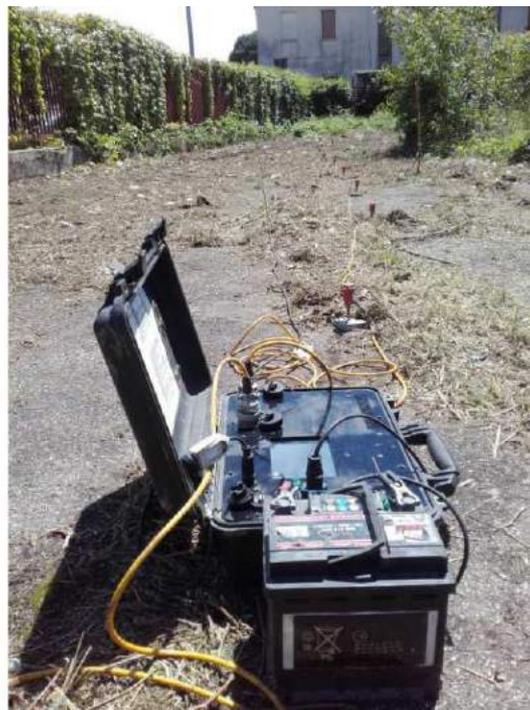
La prova MASW si basa **sull'analisi delle onde superficiali (onde di Rayleigh)** che si propagano entro un semispazio stratificato e consente di ricostruire **l'assetto sismo-stratigrafico** del sottosuolo.
