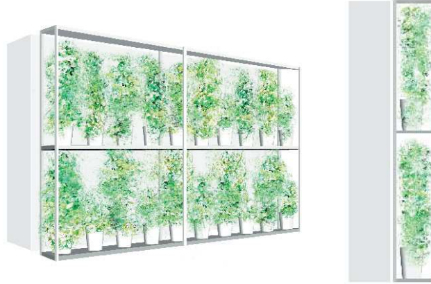
Fig.5 Schema indicativo di parete verde con messa a dimora delle piante in contenitori: sistema integrato nella facciata.
