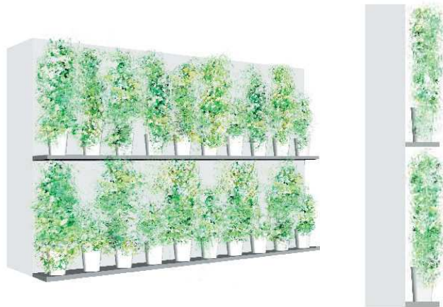
Fig.5 Schema indicativo di parete verde con messa a dimora delle piante in contenitori: sistema integrato nella facciata.
