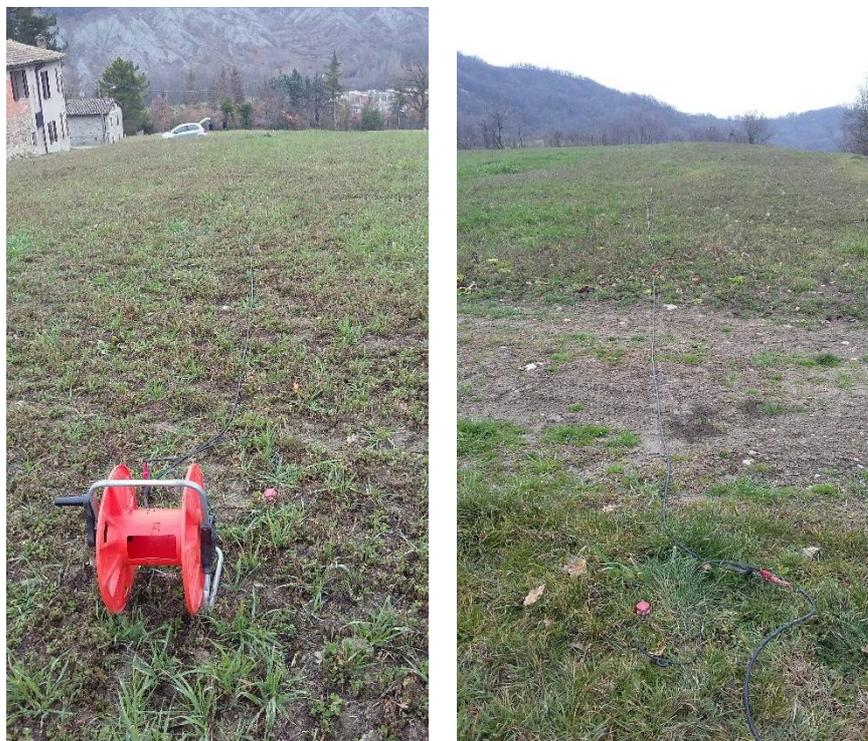
*Figura 2. Stendimento sismico.*
