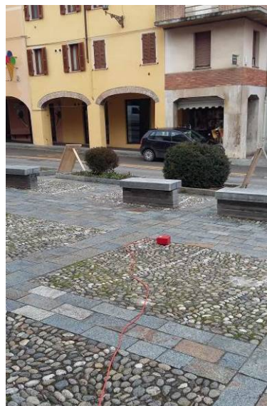
Figura 3. Stendimento sismico (a sinistra) e acquisizione HVSR (a destra).
