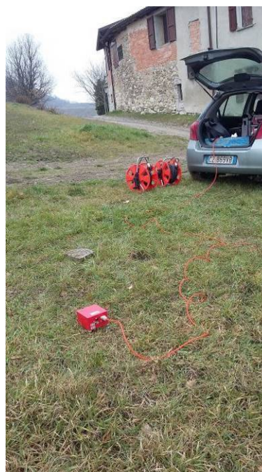
Figura 10. Stendimento sismico (a sinistra) e acquisizione HVSR (a destra).
