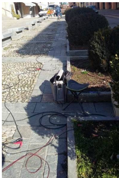
Figura 3. Stendimento sismico (a sinistra) e acquisizione HVSR (a destra).
