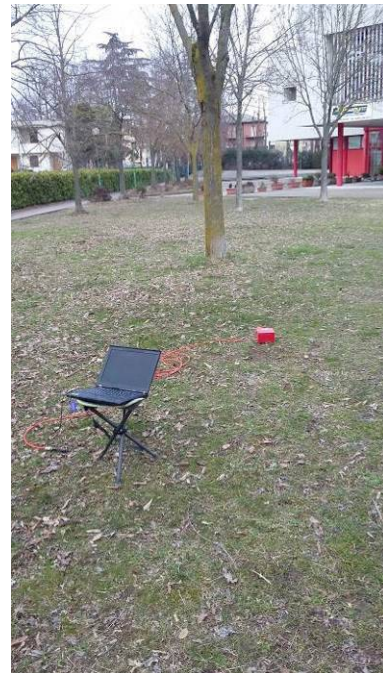
Figura 17. Stendimento sismico (a sinistra) e acquisizione HVSR (a destra).
