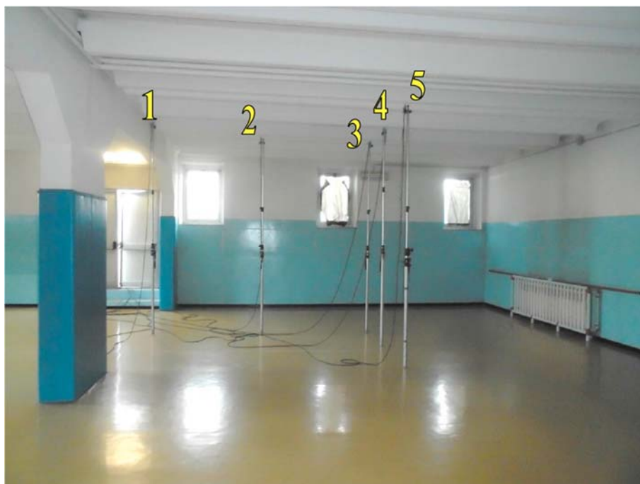
I sensori montati su aste telescopiche
