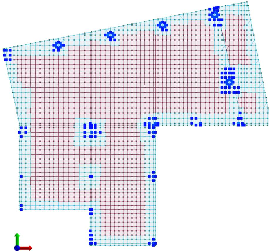
Per la convenzione del software il momento negativo sulle piastre tende le fibre inferiori inoltre la direzione X è la direzione orizzontale rispetto al piano della platea mentre la direzione Y è la direzione verticale rispetto al piano della platea.
